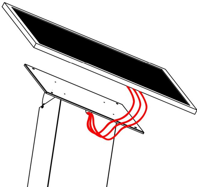
2/ Positionner l'écran sur la borne et le visser à l'aide des 4 vis et de l'outil fourni
