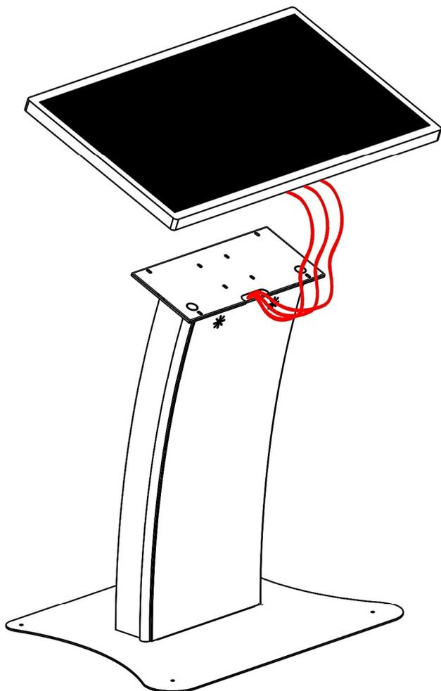
2/ Positionner l'écran sur la borne et le visser à l'aide des 4 vis et de l'outil fourni
