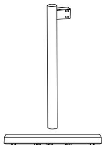
1. Ouvrez la boîte de l'emballage, sortez le support et la base, alignez avec la position du châssis et insérez le support
