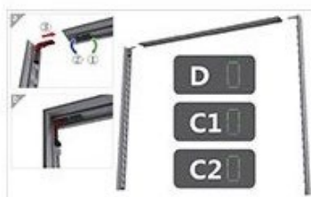
Étape 3 : Assembler la barre du haut (D) avec les 2 autres (C1 et C2) et brancher les fils. Ne pas assembler directement avec le bloc du bas.
