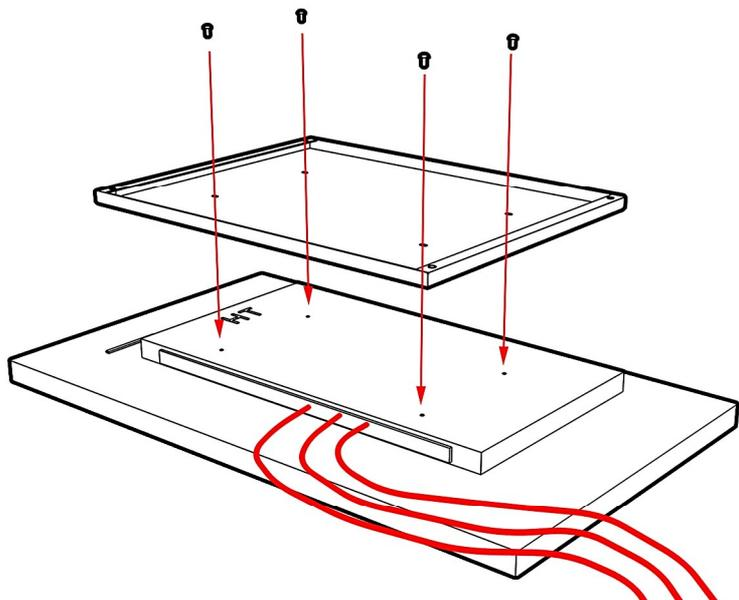
2/ Positionner l'écran sur la borne et le visser à l'aide des 4 vis et de l'outil fourni
